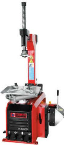
Автоматический шиномонтажный станок нового поколения для обслуживания колес наиболее распространенных типоразмеров. Позволяет обслуживать стальные и легкосплавные диски. Большой поворотный стол октогональной формы с четырехкулачковым механизмом зажима дисков надежно фиксирует колеса диаметром до 1143 мм и шириной до 406 мм. Интегрированная в зажимные кулачки система взрывной накачки с внешним резервуаром без труда справится с накачкой низкопрофильных шин.
