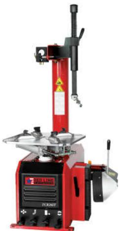
Полуавтоматический шиномонтажный станок нового поколения для обслуживания колес наиболее распространенных типоразмеров. Позволяет обслуживать стальные и легкосплавные диски. Большой поворотный стол октогональной формы с четырехчулаковым механизмом зажима дисков надежно фиксирует колеса диаметром до 1143 мм и шириной до 406 мм. Интегрированная в зажимные кулачки система взрывной накачки с резервуаром, встроенным в колонну, без труда справится с накачкой низкопрофильных шин.
